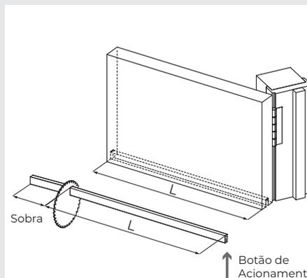
\*Nota: Se o comprimento do Veda Porta Automático for menor que 430mm, ele não poderá ser cortado. Se o comprimento do Veda Porta Automático for maior que 430mm, ele poderá ser cortado no máximo 150mm (Sobra=150mm).
