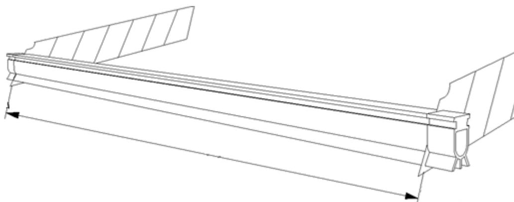
**7º Passo:** Insira o Veda Porta Automático no vão realizado na base da porta à ser instalado. Após inserção, o equipamento deverá ficar pressionado e firme. Não há necessidade de utilizar parafusos para fixação do equipamento.
