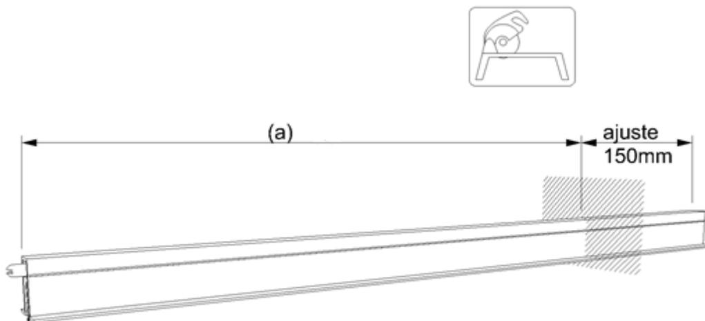
**5º Passo:** Após realizar o ajuste, retire o perfil interno do equipamento e realize um corte de 5 mm na extremidade oposta ao pino de acionamento. O mesmo deverá ser 5 mm menor que a parte externa.
