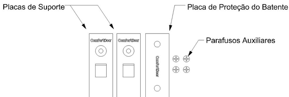
**2º Passo:** Realize um corte central em toda a base inferior da porta para fixação do equipamento, com estas medidas: 34 (mm) de altura; 14 (mm) de largura; comprimento total da base;
