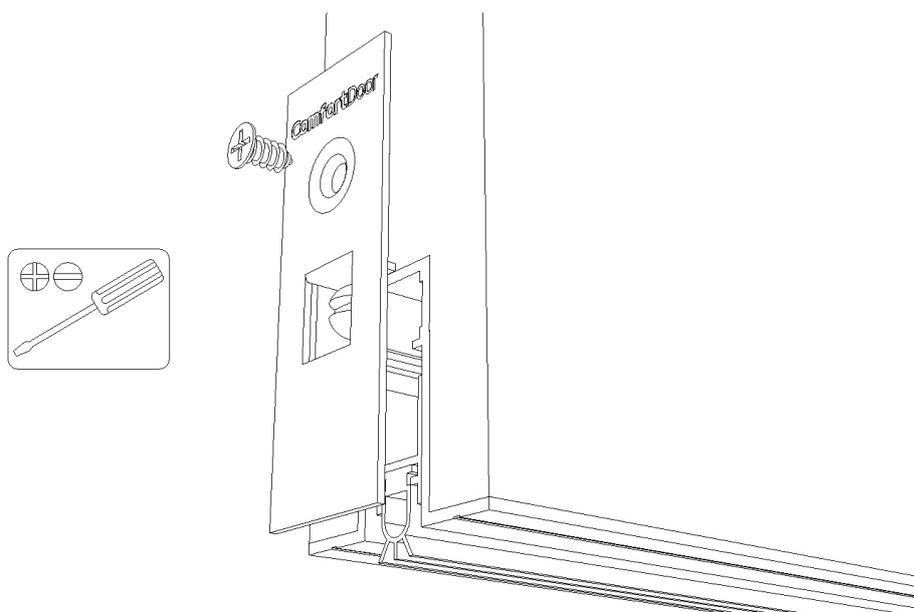
**9º Passo:** Parafuse a placa de proteção de batente no batente da porta de acordo com a posição de contato do pino de acionamento do equipamento com o auxílio de uma furadeira elétrica ou uma chave Philips.
