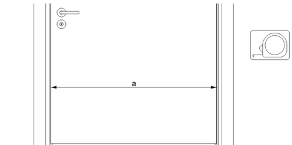
**4º Passo:** Caso o equipamento não esteja na medida adequada, realize um ajuste com o auxílio de uma serra circular. O ajuste máximo possível é de 150 mm e deverá ser realizado na extremidade oposta ao pino de acionamento.
