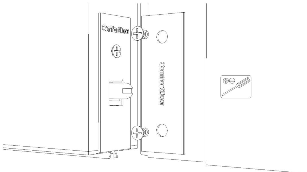
**10º Passo:** Ajuste a pressão da vedação girando o pino acionador com o auxílio de uma chave de fenda até obter a pressão necessária do equipamento sobre o piso ou soleira.
